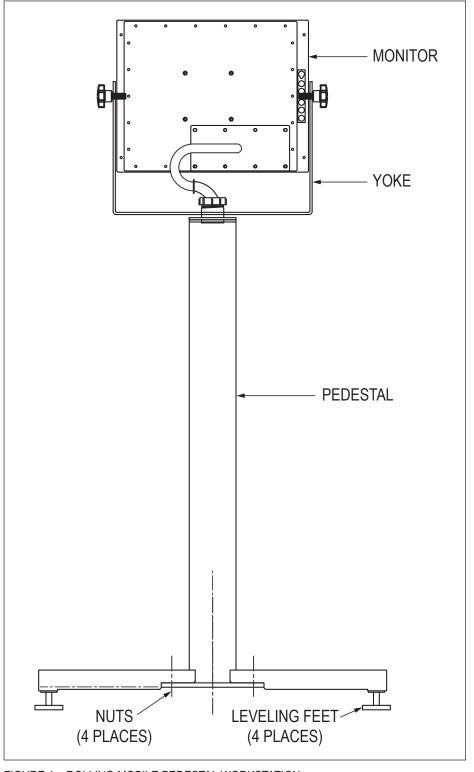
FIGURE 1 – ROLLING MOBILE PEDESTAL WORKSTATION
